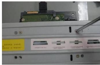
5. Utilice tornillos para fijar el HDD.
