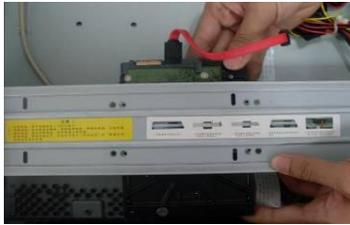
4. Alineé el HDD con los cuatro agujeros del soporte HDD.
