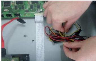
7. Libere el cable de conexión del HDD.
