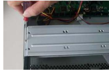
6. Instale el soporte superior y utilice tornillos para fijar el HDD al soporte.
