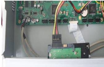
8. Conecte el cable de alimentación del HDD.
