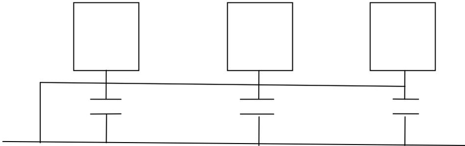
Cuando se conectan dispositivos de gran tamaño (la dimensión física del dispositivo y el cable de conexión son grandes en comparación con la longitud de onda de la interferencia que exista), entonces existe la posibilidad de que se produzca interferencia cuando la corriente atraviesa el chasis y el cable. En esta situación, el camino de la interferencia habitualmente queda encerrado en el circuito de tierra del sistema.
