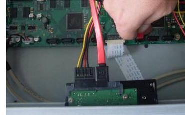
9. Utilice un cable de datos para conectar el HDD y el puerto SATA. Cierre el chasis y apriete los tornillos con firmeza.
